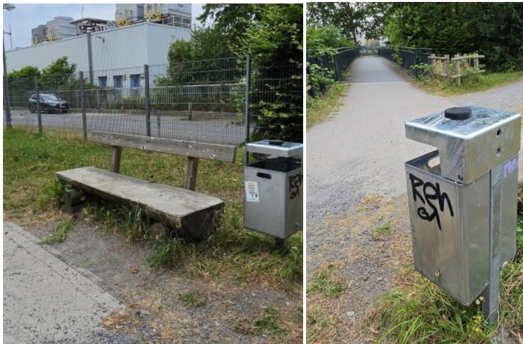
Füllstandsensor auf dem Dach angebracht
